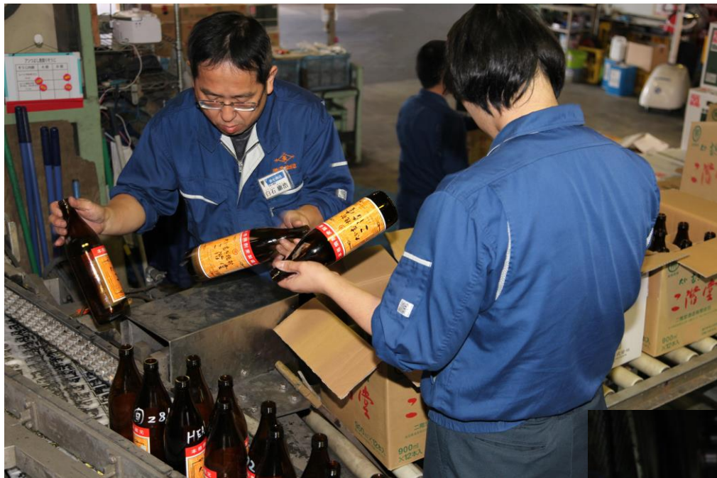
ライン投入時にびん底を目視検査
