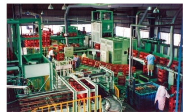
P箱の洗浄の様子
